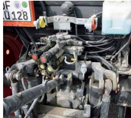
Es gibt drei Steuergeräte, leider nur eins mit Schwimmstellung. Eines kann auf einfach wirkend umgestellt werden.
