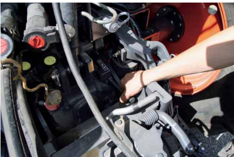
Zum Umschalten der Zapfwelldrehzahl muss man absteigen.
